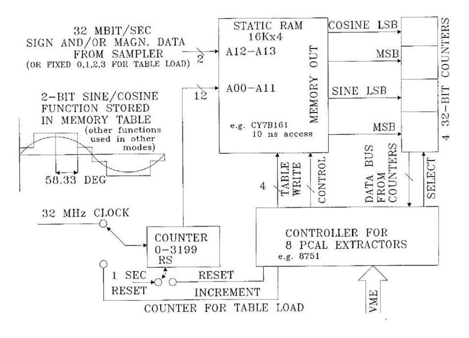
FIGURE BLOCK DIAGRAM OF PCAL EXTRACTOR
